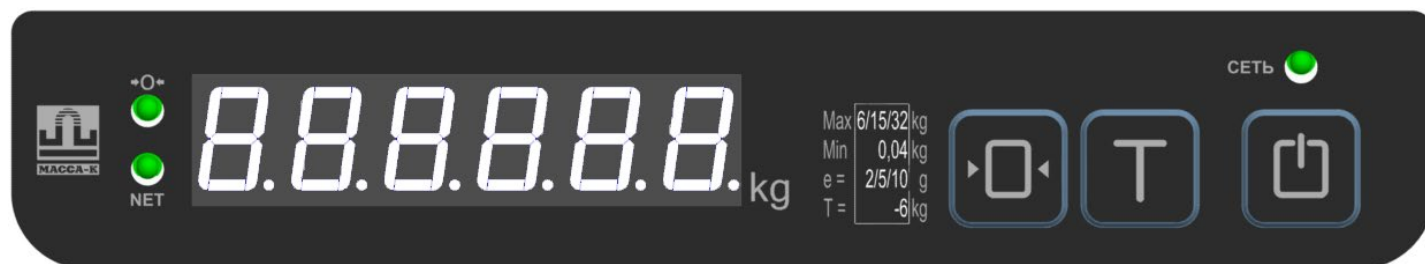
Рисунок 2 – Лицевая панель устройства управления. Клавиатура
